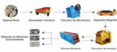
**Figura 25.** Esquema de uma usina de reciclagem de RCC's.
